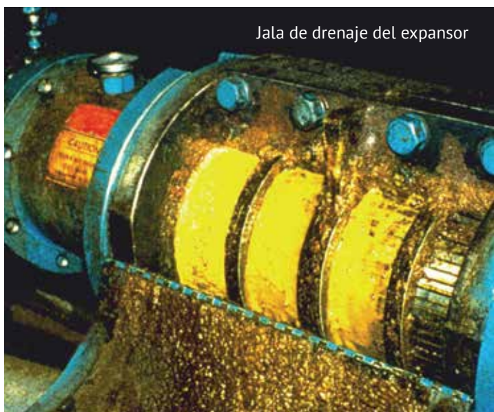
Obturador de cono hidráulico en Solvex™
